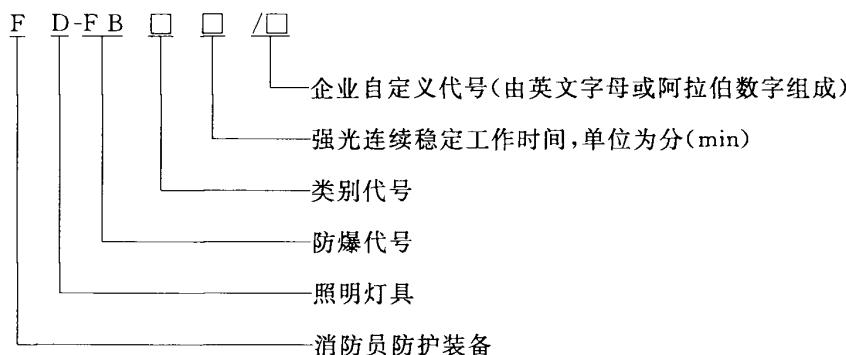
示例: FD-FBS I 240/A 表示强光连续稳定工作时间为 240 min 的手提式 I 型防爆类消防员照明灯具,企业自定义代号为 A。
